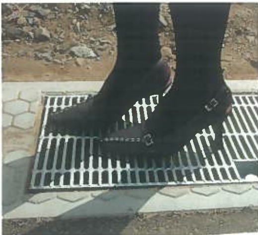
グレーチング・ハイヒール歩行確認
